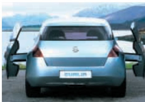
Dvere sa otvárajú elektronicky a odsávajú sa po boku vozidla. Priestor na vystupovanie a nastupovanie je preto maximálny
