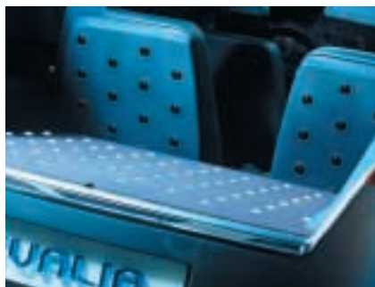
Pri uložení nákladu sú guľčky pod ním zasunuté, ostatné zostanú vysunuté. Udržia tak bremeno počas jazdy
